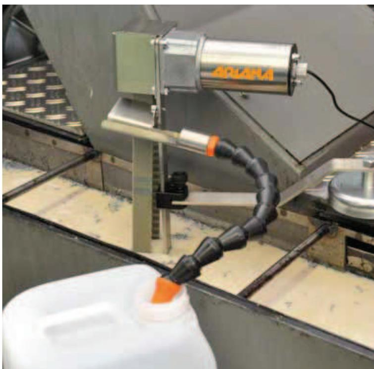
Der Bandskimmer wird über dem Flüssigkeitsbehälter mittels Magnetplatte befestigt, am besten auf der dem Flüssigkeitseinlauf gegenüberliegenden Seite. Die Grundplatte der Antriebseinheit muss ungefähr 300 mm über dem höchsten Flüssigkeitsniveau angebracht werden. An dem Auslaufstutzen wird der Schlauch angebracht, der in ein Absetzbecken geleitet wird.
