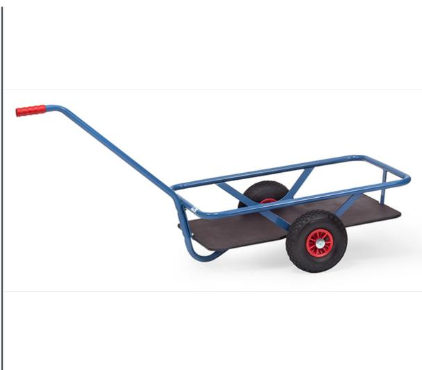
Char à bras léger en tube et profilé d'acier soudés, revêtement époxy bleu RAL 5007. Timon à boulonner. Plateau en contreplaqué hydrofuge. Roues à bandage caoutchouc, moyeu à roulement à billes. Livré non monté, montage facile.
