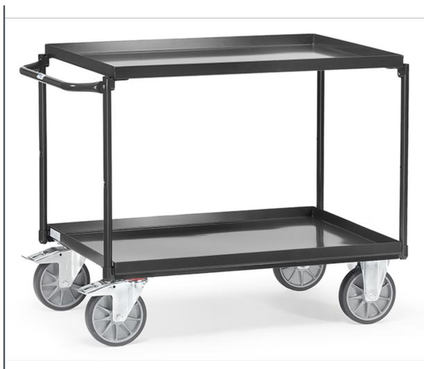
Construction en acier avec 2 plateaux étanches et rebord de 40 mm, revêtement époxy gris anthracite RAL 7016, dossier de poussée horizontal. Charge maximum plateau du haut : 200 kg. 2 roues pivotantes et 2 roues fixes à bandage TPE, moyeu à roulement à billes central. Freins sur roues pivotantes conformément à la Norme 1757-3 (Sécurité des chariots de manutention).
