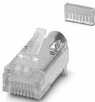
Stifteinsatz RJ45, CAT5, 8-polig, geschirmt, IDC-Anschlussstechnik, für Litze AWG 27 ... 26, mit Zugentlastung
