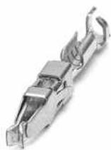
Buchsenkontakt, wird nach dem Ankrimpen des Leiters in das Steckerteil geschoben, für die Modulsteckergehäuse MCC 1...-STZ-3,81 und MCC 1...-STZF-3,81, für Querschnittsbereiche von  $0,2 \text{ mm}^2$  bis  $0,34 \text{ mm}^2$
