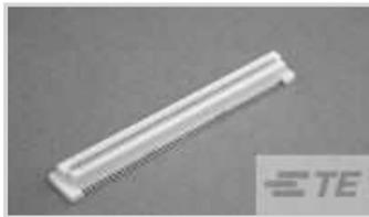
PCB-Steckverbindermontagetyp: **Buchse für die Leiterplattenmontage**Montageausrichtung für Leiterplatte: **Vertikal**Steckverbindersystem: **Leiterplatte-an-Leiterplatte**Anzahl von Positionen: **100**Raster: **.8 mm [.031 in]**[Alle FH-Buchsensteckverbinder: Leiterplatte-an-Leiterplatte, vertikal, 100, 0,8 mm \(24\)](#)**Eigenschaften****Produktmerkmale**
