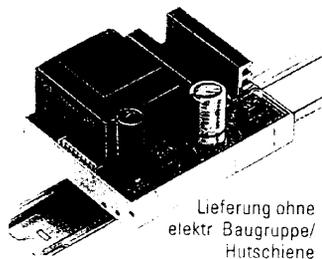
Je nach Modulgröße sind dann ein oder mehrere Fußelemente vorzusehen. Vorteile: schneller Zusammenbau durch steckbares Baukastenprinzip · Hohe Verwindungssteifigkeit durch feste Verzapfung der einzelnen Elemente · Durch Universalfuß auf alle DIN EN-Hutschienen aufzurasten · Vielfältige Anschlußtechnik in der Elektronik · Beschriftungsmöglichkeit an den Seitenelementen. Für Platinengrößen: 93 x 22/93 x 34,8/93 x 45 33 x 67/93 x 89,6/93 x 111,6 mm. Bauhöhe 96 mm.
