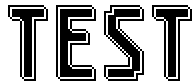
Nochmalige Überlagerung (EXOR) der "Outline Schrift" an Pos.2,2. führt zu einer "Outline Schrift mit Füllung"
