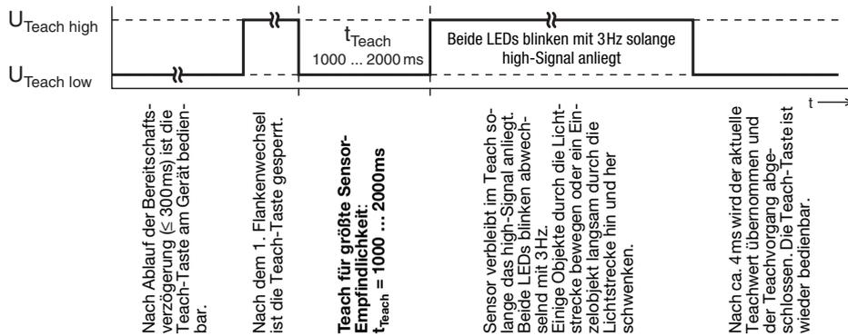
Beim Auftreten eines Teachfehlers (z.B. kein, zu kleines oder zu transparentes Teach-Objekt durch die Lichtstrecke geschwenkt) blinken die beiden LEDs gleichzeitig schnell. System überprüfen, Teachvorgang wiederholen, ggf. größeres oder weniger transparentes Teach-Objekt verwenden.
