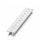
Zackband, Streifen, weiß, beschriftet, beschriftbar mit: CMS-P1-PLOTTER, längs bedruckt: gleiche Zahlen 1 oder 2 usw. bis 100, Montageart: verrasten, für Klemmenbreite: 6,2 mm, Schriftfeldgröße: 6,15 x 10,5 mm, Anzahl der Einzelschilder: 10
