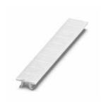
Marker für Klemmen, Streifen, weiß, beschriftet, beschriftbar mit: CMS-P1-PLOTTER, längs: L1, L2, L3, N, PE, L1, L2, L3, N, PE, Montageart: verrasten, für Klemmenbreite: 6,2 mm, Schriftfeldgröße: 6,15 x 10,5 mm, Anzahl der Einzelschilder: 10
