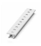
Zackband, Streifen, weiß, beschriftet, beschriftbar mit: CMS-P1-PLOTTER, längs bedruckt: fortlaufende Zahlen 1 ... 10, 11 ... 20 usw. bis 491 ... 500, Montageart: verrasten, für Klemmenbreite: 6,2 mm, Schriftfeldgröße: 6,15 x 10,5 mm, Anzahl der Einzelschilder: 10
