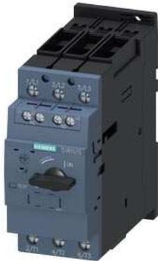
Leistungsschalter Baugröße S2 für den Motorschutz, CLASS 20 A-Auslöser 22...32 A N-Auslöser 416 A Schraubanschluss Standardschaltvermögen mit querliegenden Hilfsschalter 1S+1Ö
