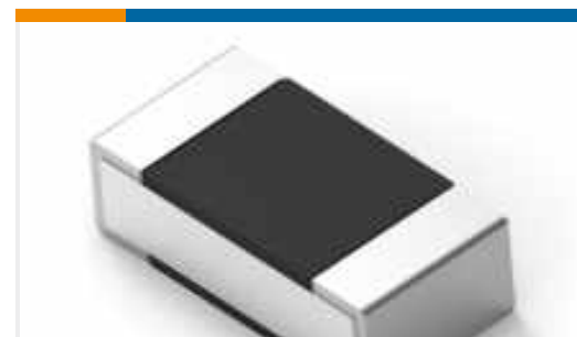
TE Teilnr.:9-2176306-6 RP 1E 0.1W 11K3 0.1% 25PPM 5K RL
