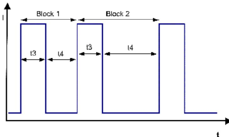
Block1: spezieller Blockierschutz 5 Zyklen  $t_3 / t_4 = 0,6$  s / 1 s Block2: Blockierschutz  $t_3 / t_4 = 0,6$  s / 10 s
