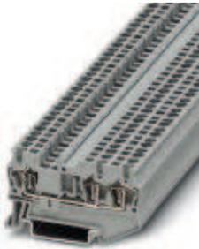
Morsetto passante, Collegamento: Connessione a molla, Sezione:0,08 mm<sup>2</sup> - 4 mm<sup>2</sup>, AWG: 28 - 12, Larghezza: 5,2 mm, Colore: grigio, Tipo di montaggio: NS 35/7,5, NS 35/15
