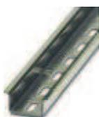
Guida di supporto, materiale: acciaio zincato e passivato a strato spesso, perforato, altezza 15 mm, larghezza 35 mm, lunghezza: 2000 mm
