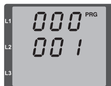
Abb. Programmier-Modus Parameteranzeige Über die Tasten 1 und 2 können die einzelnen Parameter geändert werden (vgl. Seite 36).
