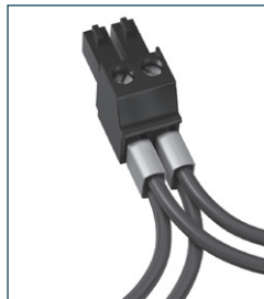
2-poliger Steckkontakt mit Kabelanschluss (Kabeltyp: 2 \times 0,75 \text{ mm}^2 ) über Twin- Aderendhülsen
