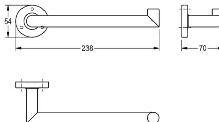
Handtucharm für Wandmontage, Edelstahl, Oberfläche hochglanzpoliert, runde Abdeckung zum Verbergen der Befestigung der Schrauben, inklusive Edelstahlschrauben und Dübel.
