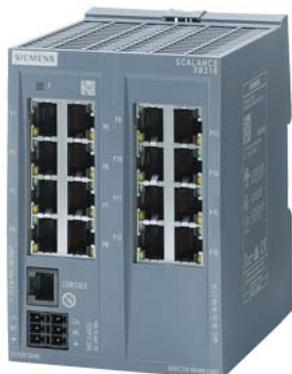
SCALANCE XB216 managebarer Layer 2 IE Switch, 16X 10/100 Mbit/s RJ45 Ports, 1x Konsolen-Port, Diagnose-LED red redundante Spannungsversorgung; IEC 62443-4-2 zertifiziert; Temp.-Bereich 0 bis +60°C Hutschienenmontage; Default-EtherNet/IP.
