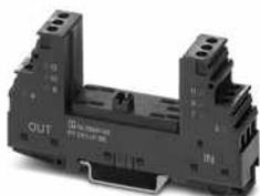
Basiselement für Schutzstecker PT mit Schutzschaltung für zwei Leiter einseitig geerdeter Signalkreise. Integrierter Gasableiter als Grobschutz zwischen GND und PE. Montage auf NS 35/7,5 und NS 35/15, Gehäusebreite: 17,5 mm.
