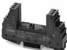
Basiselement für Schutzstecker PT mit Schutzschaltung für zwei Leiter einseitig geerdeter Signalkreise. Montage auf NS 35/7,5 und NS 35/15, Gehäusebreite: 17,5 mm.
