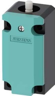
Positionsschalter Basisschalter Kunststoff 40 mm, nach DIN EN 50041 erhöhter Korrosionsschutz Geräteanschluss 1 x (M20 x 1,5) 1S/2Ö Sprungkontakte funktionsfähig bei -40 °C Schock- und Schwingprüfung nach DIN EN 61373, Kategorie 1B
