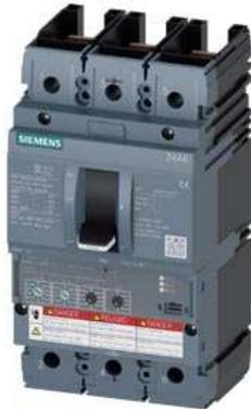
Leistungsschalter 3VA6 UL Frame 150 Schaltvermögenklasse L 150kA @ 480V 3-polig, Anlagenschutz ETU350, LSI, In=40A Überlastschutz, 100% rated Ir=16A...40A Kurzschlusschutz Isd=1,5...10 x Ir, li=12 x In ohne Anschluss
