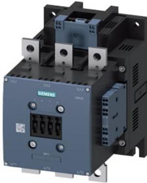
Bahnschütz AC-1, 500 A DC-Betätigung 3 polig elektronischer Antrieb mit PLC-IN 24-110 V DC Us 110 V x (0,7-1,25) Hilfskontakte 2 S + 2 Ö Schienenanschlüsse Hilfsschalter und Spulenanschlüsse in Federzugtechnik
