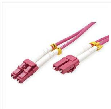
**Die OM4 Faser wird für bestehende 1 und 10 Gbit/s-Anwendungen, sowie zukünftige 40 und 100 Gbit/s verwendet. Für größere Reichweiten von über 550m bei 10 Gbit/s und Backbones geeignet. Mit einer effektiven Modalen Bandbreite von 4700 MHz-km, ist die OM4 Faser auch besonders gut für kürzere Reichweiten in Rechenzentren geeignet, sowie für High Performance Computing-Anwendungen.**
