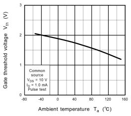
Fig. 8.8 V<sub>th</sub> - T<sub>a</sub>
