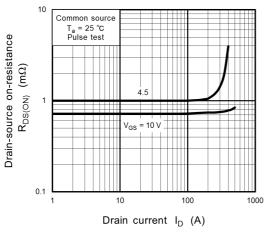
Fig. 8.5 R<sub>DS(ON)</sub> - I<sub>D</sub>
