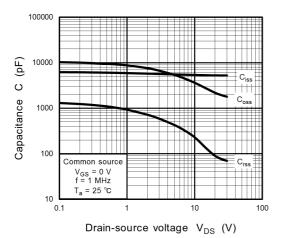
Fig. 8.11 Capacitance - V<sub>DS</sub>
