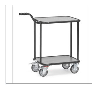
Griffroller in der Ausführung "GREY EDITION". Aus Stahlrohr geschweißt, pulverbeschichtet anthrazitgrau RAL 7016. Mit Holzplattformen. 2 Plattformen mit im Rahmen liegender Holzwerkstoffplatte, Oberfläche mittelgrau. Griff anschraubbar. 2 Lenk- und 2 Bockrollen, TPE-Bereifung (spurlos), Naben mit Rillenkugellager, Feststeller an den Lenkrollen, gemäß der Europäischen Norm EN 1757-3 (Sicherheit von Plattformwagen). Tragkraft obere Ladefläche 100 kg.
