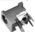
No.M04-754A0 DC JACK FOR P.C.B. (center pin : 1.65 φ mm I.D. : 5.15 φ mm) JSAJ 3 (DC 6.3V ~10.5V)
