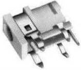
No.M04-730A0 DC JACK FOR P.C.B. (center pin : 1.65 φ mm I.D. : 4.4 φ mm) JSAJ 2 (DC 3.15V ~6.3V)
