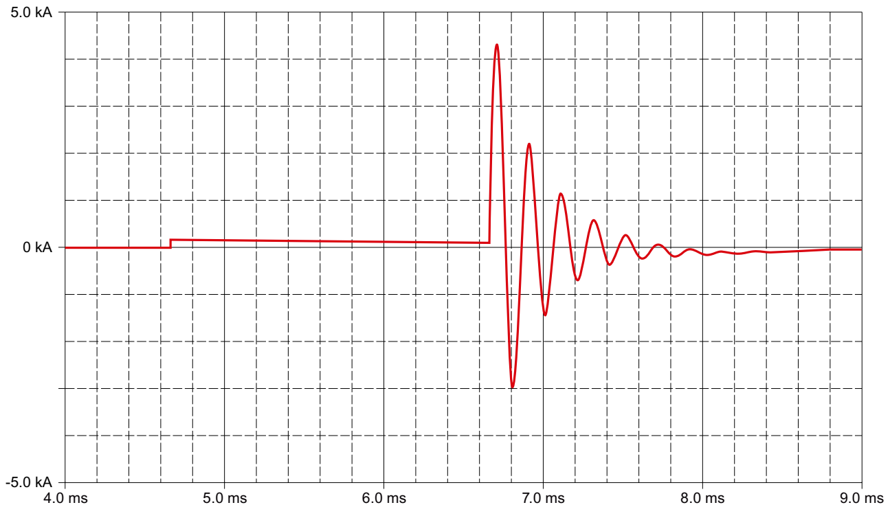
Bild 6-16 2. Einschalten mit einem Kondensatorschütz 3RT2636 (mit Vorladung) Ergebnis: Die maximale Einschaltstromspitze kann (Abhängig von der Vorladung) auf unter 5 kA reduziert werden.
