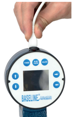
Lade-/Datenkabel (Micro-USB) in Steckerbuchse am Prüfstandskopf einstecken
