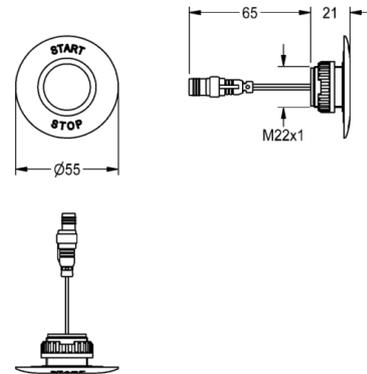
Piezo-Taster - A3000 open mit Rosette (Start-Stopp Beschriftung) und Markierungsrings rot-blau.
