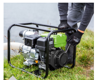
4-Takt-Motor mit Seilzugstarter: einfach zu starten unter allen Bedingungen
