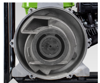
Robust, langlebig und zuverlässig: Spirale und Flügelrad aus Gusseisen
