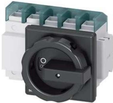
SETRON, Lasttrennschalter 3LD, Hauptschalter, 3-polig, I<sub>n</sub>: 125 A, Betriebsleistung / bei AC-23 A bei 400V: 45 kW, Frontbefestigt, 1Ö, 1S, Drehantrieb, schwarz, 4-Loch Befestigung der Handhabe
