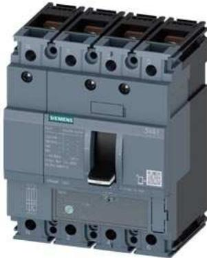
Leistungsschalter 3VA1 IEC Frame 160 Schaltvermögenklasse H Icu=70kA @ 415V 4-polig, Anlagenschutz TM220, ATFM, In=80A Überlastschutz Ir=56A...80A Kurzschlusschutz Ii=10 x In N-Leiter ungeschützt Schraubenflachanschluss
