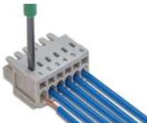
Leiter anschließen – Betätigung des CAGE CLAMP®-Anschlusses mit Schraubendreher (2,5 x 0,4) mm – rechtwinklig zur Leiteranschlussrichtung.
