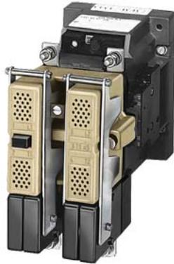
Schütz, Baugröße 12, 2-polig, Nennbetriebsstrom 400A Hilfsschalter 44E (4NO+4NC) AC 120V 60Hz/AC 100V 50Hz AC-Betätigung AC-Betätigung
