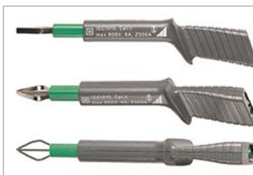
Drei selbsthaltende Prüfspitzen mit Berührungsschutz zum Anschluss von Messleitungen mit 4 mm-Bananensteckern bzw. mit berührungsgeschützten Steckern an Buchsen mit Öffnungen von 3,5 mm bis 12 mm, z. B. CEE-, Perilex-Steckdosen usw.
