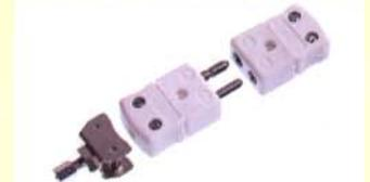
Les connecteurs en céramique sont réalisés pour des conditions d'utilisation allant jusque 650°C (Type K). Des versions standards et miniatures sont disponibles pour tous les types de thermocouples et Cu compensé (Cu/Cu) NB: pour les types R et S la température ambiante maximale est de 260°C
