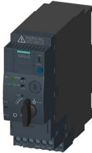
SIRIUS, KOMPAKTABZWEIG, DIREKTSTARTER 400 V, AC/DC 110 ... 240 V, 50 ... 60 HZ, 8 ... 32 A, IP20, ANSCHLUSS HAUPTSTROMKREIS: STECKBAR, OHNE KLEMMEN, ANSCHLUSS HILFSSTROMKREIS: SCHRAUBANSCHLUSS
