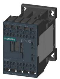
CONTACTOR, AC-3, 7.5KW/400V, 1NC, DC 24V, 3-POLE, SZ S00 SPRING-LOADED TERMINAL .
