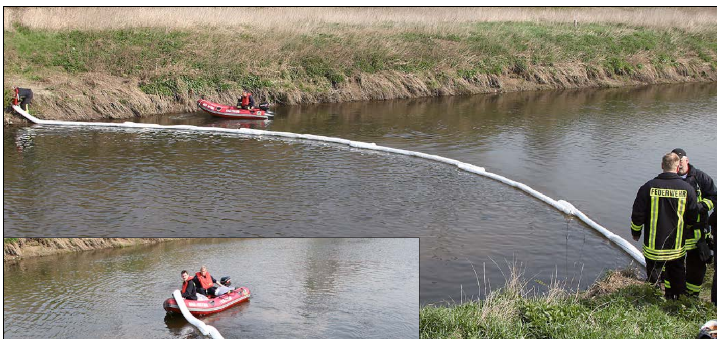
DENSORB Ölsperren (hier: 6-m-Segmente) zum Eindämmen und Aufnehmen von Ölverschmutzungen auf Wasseroberflächen
