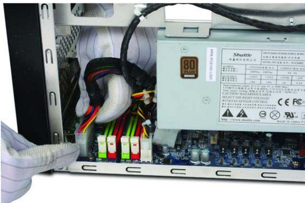
③ Verbinden Sie den 20-poligen ATX-Stecker und den 2x2-poligen (oder 1x4-poligen) Stecker mit dem Mainboard.
