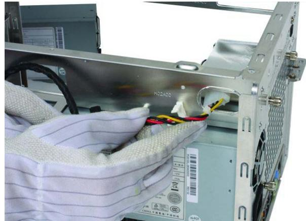
② Führen Sie das Stromkabel für die Festplatten durch die Durchführung im Chassis (wie auf dem Bild gezeigt) und verbinden es mit den Laufwerken.
