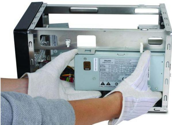
① Setzen Sie das Netzteil an die Einbauposition und befestigen Sie es mit drei Kreuzschlitzschrauben von der Rückseite.
