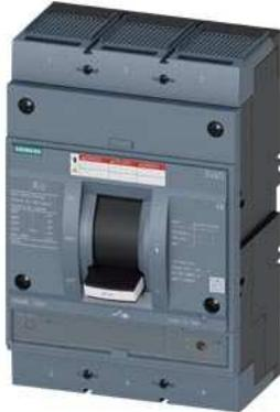
Leistungsschalter 3VA5 UL Frame 800 Schaltvermögenklasse H 65kA @ 480 V 3-polig, Anlagenschutz TM230, FTAM, In=600A Überlastschutz, 100%-rated Ir=600A fest eingestellt Kurzschlusschutz li=5...10 x In beidseitig Kabelanschluss
