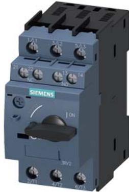
Leistungsschalter Baugröße S0 für den Motorschutz, CLASS 10 A-Auslöser 9...12,5 A N-Auslöser 163 A Schraubanschluss Standardschaltvermögen mit querliegenden Hilfsschalter 1S+1Ö
