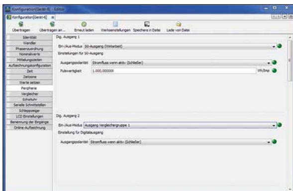
Abb. Konfiguration der digitalen Ausgänge über die Software GridVis<sup>®</sup>
