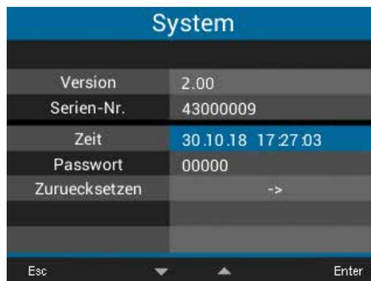
Abb. Die Zeit überprüfen Sie unter Menü Konfiguration > System > Zeit.
