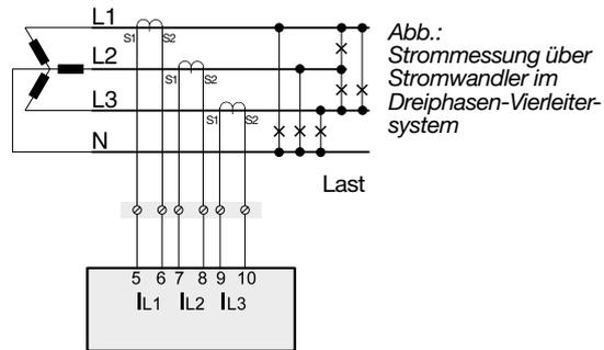
Abb.: Strommessung über Stromwandler im Dreiphasen-Vierleitersystem
