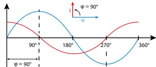
Bei einer Kombination der Zustände kann der Phasenwinkel „Strom zu Spannung“ Werte zwischen  $-90^\circ$  und  $+90^\circ$  annehmen.
