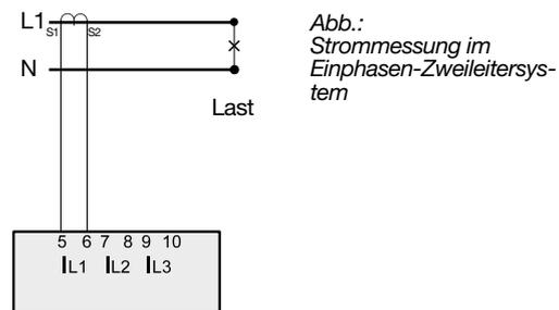
Abb.: Strommessung im Einphasen-Zweileitersystem
