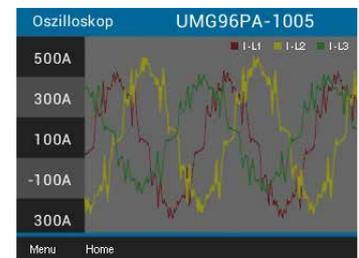
Anzeige Oszillogramm der Ströme von L1, L2 und L3
