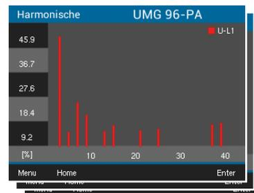
Anzeige der Harmonischen bis zur 40. (Spannung L1, L2, L3)
