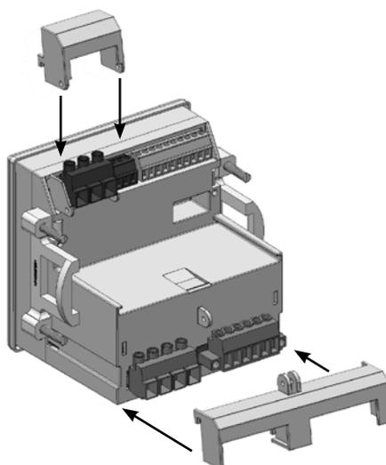
Abb. Installation der Klemmabdeckungen am Gerät
