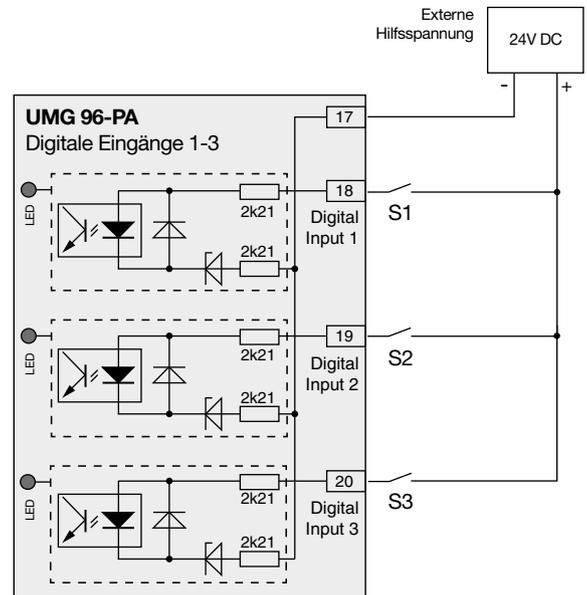
Abb. Beispiel für den Anschluss der externen Schaltkontakte S1-S3 an die digitalen Eingänge 1, 2 und 3.
