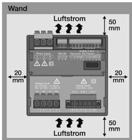
Abb. Rückansicht der Einbaulage des UMG 96-PA
