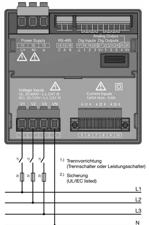
Abb. Anschlussbeispiel für die Spannungsmessung.
