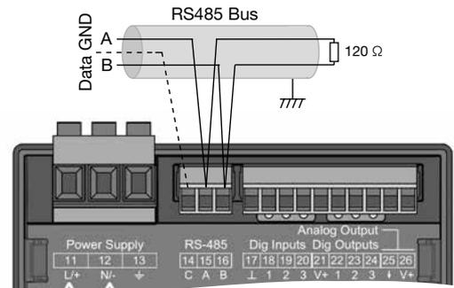
Abb. RS485-Schnittstelle, 3-poliger Steckkontakt mit Abschlusswiderstand (Art.-Nr. 52.00.008)
