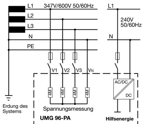
Abb. Bsp. Prinzipschaltbild (UMG 96-PA) - Messung in Dreiphasen-4-Leitersystemen.
