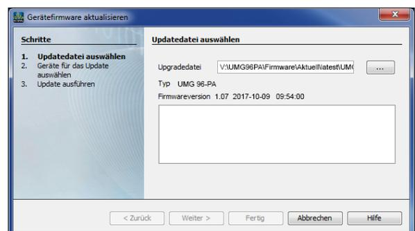
Abb. Geräte-Firmware aktualisieren in der Software GridVis®
