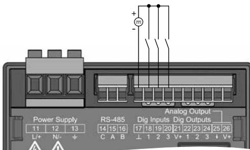
Abb. Anschluss digitalen Eingänge
