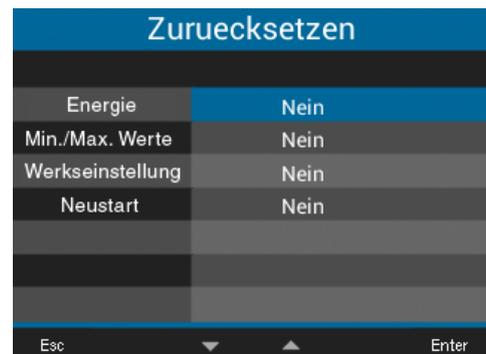
Abb. Fenster Zurücksetzen, Reset der Energiezähler
