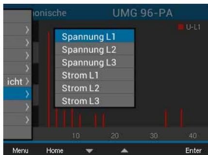
Abb. Auswahlliste mit Spannungen und Strömen zur Anzeige der Harmonischen.
