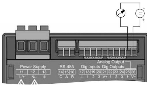
Abb. Anschluss Analogausgang
