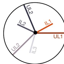
Strom und Spannung sind gegeneinander verschoben. Der Strom eilt der Spannung voraus, d.h. das Netz wird kapazitiv belastet.
