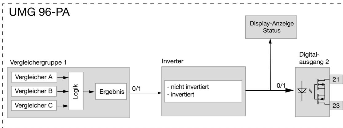
Abb. Blockschaubild "Verwendung des Digitalausgangs 2 zur Grenzwertüberwachung"
