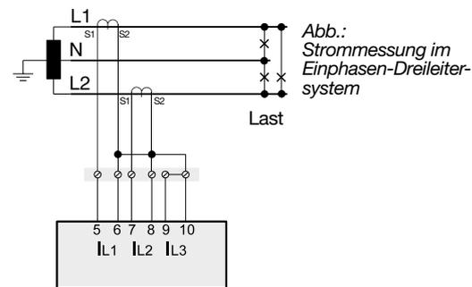
Abb.: Strommessung im Einphasen-Dreileitersystem
