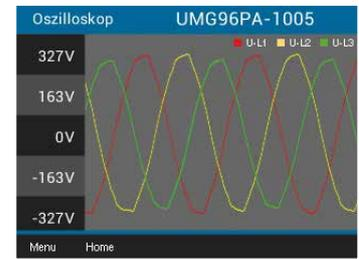
Anzeige Oszillogramm der Spannungen L1, L2 und L3
