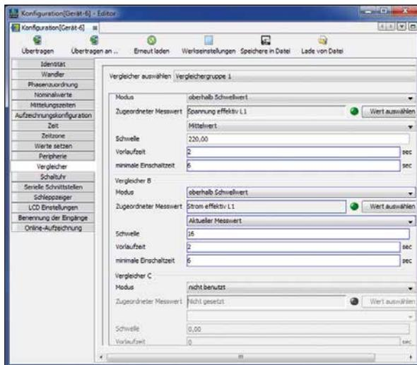
Abb. Konfiguration der Vergleicher in der Software GridVis®
