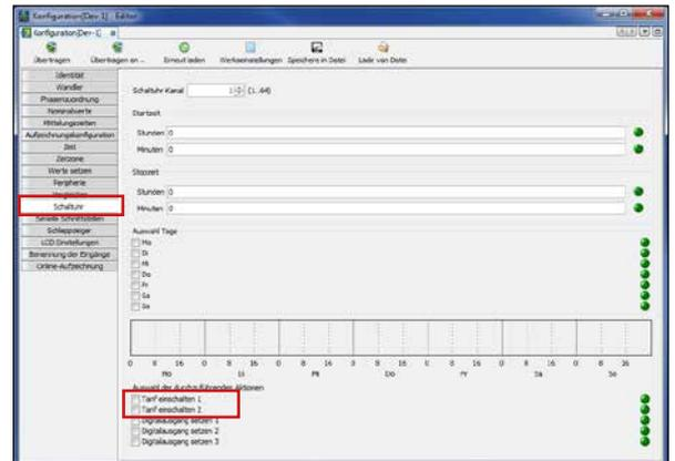
Abb. Schaltuhr-Konfiguration in der Software GridVis®
