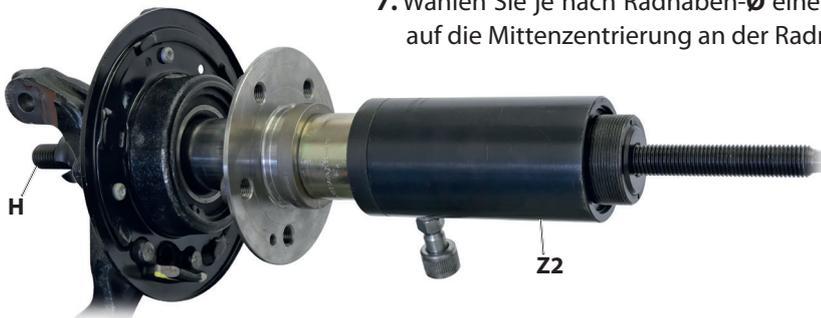
8. Bereiten Sie den Hydraulik-Zylinder [Z2] wie gezeigt, entsprechend vor und Setzen diesen nachfolgend mit der **ZUGSEITE** am Radlager ein.
