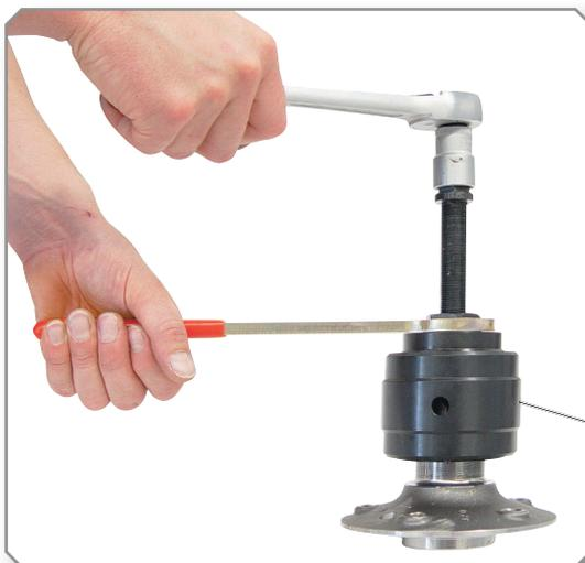
ⓘ Wird die Radnabe wieder verwendet muss zuvor der Radlagerinnenring abgezogen werden. Beispielsweise mit Hilfe des als **Zubehör** erhältlichen **Lagerinnenring Abziehersatzes - KL-0042-90 K**
