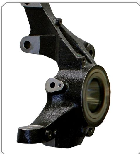
**5.** Überprüfen Sie die korrekte Einbaulage der Radlagers nach Herstellervorgaben, entfernen das Radlagerwerkzeug und setzen gegebenenfalls den Radlager-Sicherungsring am Achsschenkel ein.
