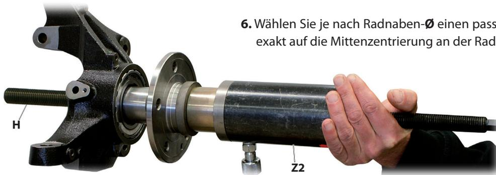
6. Wählen Sie je nach Radnaben- $\emptyset$  einen passenden Druckring [P..], welcher exakt auf die Mittenzentrierung an der Radnabe passt.
