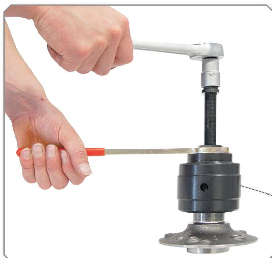
ⓘ Wird die Radnabe wieder verwendet muss zuvor der Radlagerinnenring abgezogen werden. Beispielsweise mit Hilfe des als *Zubehör* erhältlichen **Lagerinnenring Abziehsatzes - KL-0042-90 K**
