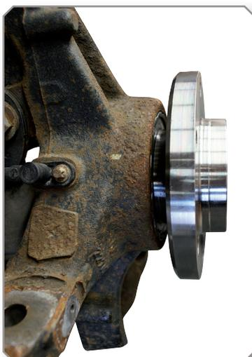
8. Überprüfen Sie die korrekte Einbaulage der Radlagereinheit, entfernen das Radlagerwerkzeug und bauen das Fahrzeug nach Herstellervorgaben wieder zusammen.
