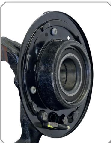
6. Überprüfen Sie die korrekte Einbaulage der Radlagers nach Herstellervorgaben, entfernen das Radlagerwerkzeug und setzen gegebenenfalls den Radlager-Sicherungsring am Achsschenkel ein.
