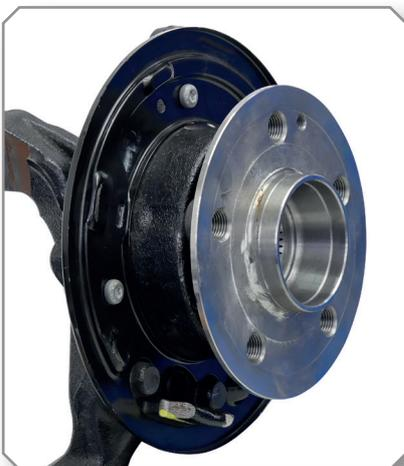
12. Überprüfen Sie die korrekte Einbaulage der Radnabe, entfernen das Radlagerwerkzeug und bauen das Fahrzeug nach Herstellervorgaben wieder zusammen.
