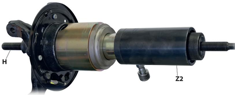
2. Bereiten Sie den Hydraulik-Zylinder [Z2] wie gezeigt, entsprechend vor und Setzen diesen mit der **ZUGSEITE** am Radlager ein.
