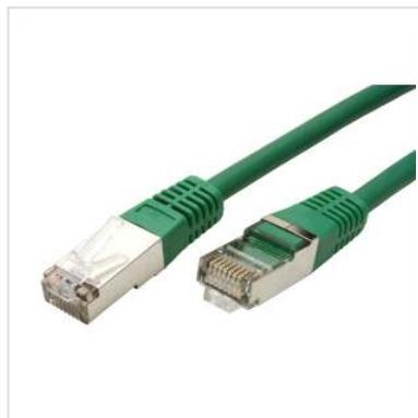
Cordon confectionné avec des connecteurs blindés RJ45 de qualité. Résistant grâce aux connecteurs surmoulés, assignation des connecteurs 1:1 selon la norme EIA / TIA 568A. Structure: tresse de 8 fils, blindage total par feuille d'aluminium. Contacts dorés.
