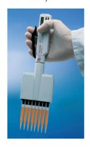
Ob Pipettieren, Dispensieren, Dilutieren oder Absaugen – die labopette® electronic ist flexibel programmierbar. Sie können nicht nur ein vorgegebenes Volumen aufnehmen und wieder komplett abgeben, sondern auch mehrfach hintereinander dasselbe oder alternativ unterschiedliche Teilvolumen abgeben. Mehr noch: Über vorgegebene Volumina können Mikrotiterplatten serienmäßig entleert werden.
