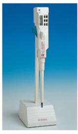
Ladeständer für labopette<sup>®</sup> electronic. Automatische Induktivladung für ca. 1000 Pipettierschritte. Aufladezeit bei leerem Akku ca. 10 Stunden. Überladesicher.
