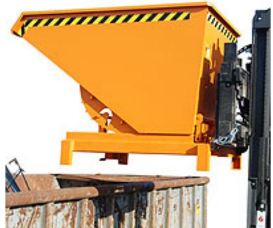
Abrutschen und Auskippen. Lackiert oder feuerverzinkt nach EN ISO 146. Tragkraft: 4000 kg. Orange (RAL 2000) Rot (RAL 3000) Blau (RAL 5012) Grün (RAL 6011) Grau (RAL 7005) Feuerverzinkt (EN ISO 1461) Typ SK 1200 Muldeninhalt: 1,20 m<sup>3</sup> Maße: L 1720 x B 1070 x H 1240 mm Gewicht: 355 kg (lackiert), 380 kg (verzinkt)
