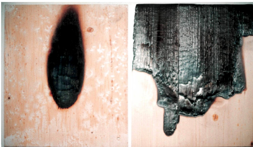
Brandtest: Fichtenholz behandelt Umgebungstemperatur: 200° C Beflammungsart: Gasbrenner Beflammungszeit: 2 Minuten
