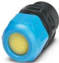
Kabelverschraubung, Material Verschraubung: PA, Anwendung: Ex, Kabelaußendurchmesser 3 mm ... 6 mm, Schirmung: nein, Anschlussgewinde: M12 x 1,5, Farbe: schwarz/blau, mit Flachdichtung
