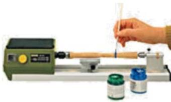
Die elektronische Drehzahlregelung ermöglicht im unteren Bereich sogar eine "halbautomatische Farbgebung".
