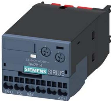
Elektronisch zeitverzögerter Hilfsschalter, rückfallverzögert, mit Steuersignal, Relais: 1 W, Zeitbereich 0,05-100 s, AC/DC 24-240 V, 50/60 Hz, Varistor zur Bedämpfung der Schützspulen integriert, Federzuganschluss, frontseitig aufschraubbar auf Schütze 3RT2 und Hilfsschütze 3RH2
